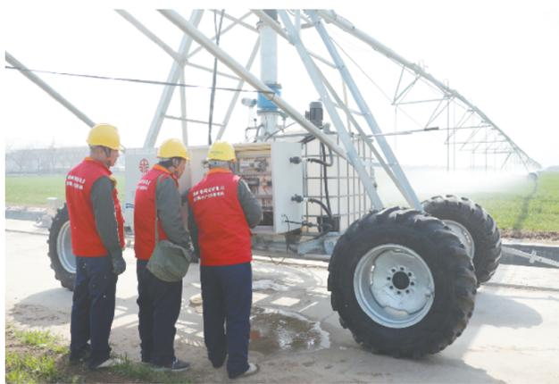
供电检修人员正在检查大型电动平移式喷灌机线路。
